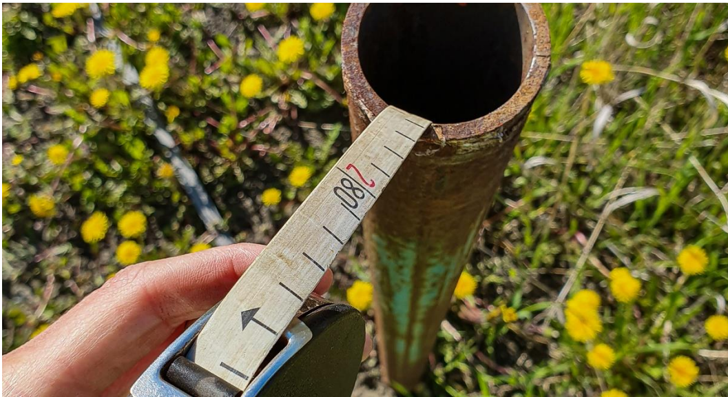
I grundvattenrör kan grundvattennivån mätas under markytan.
